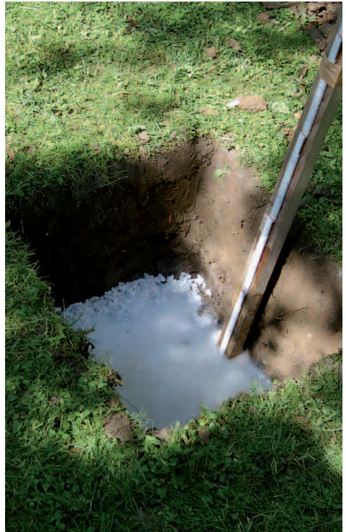
Abb. 4: Sickerversuche geben Auskunft über die Sickerfähigkeit der Böden
